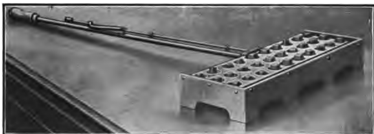
FIG. 29.—CUPEL CHARGING DEVICE. (Keller.)
